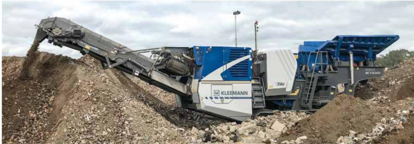
**Mobiler Backenbrecher MOBICAT MC 110(i) EVO2**
